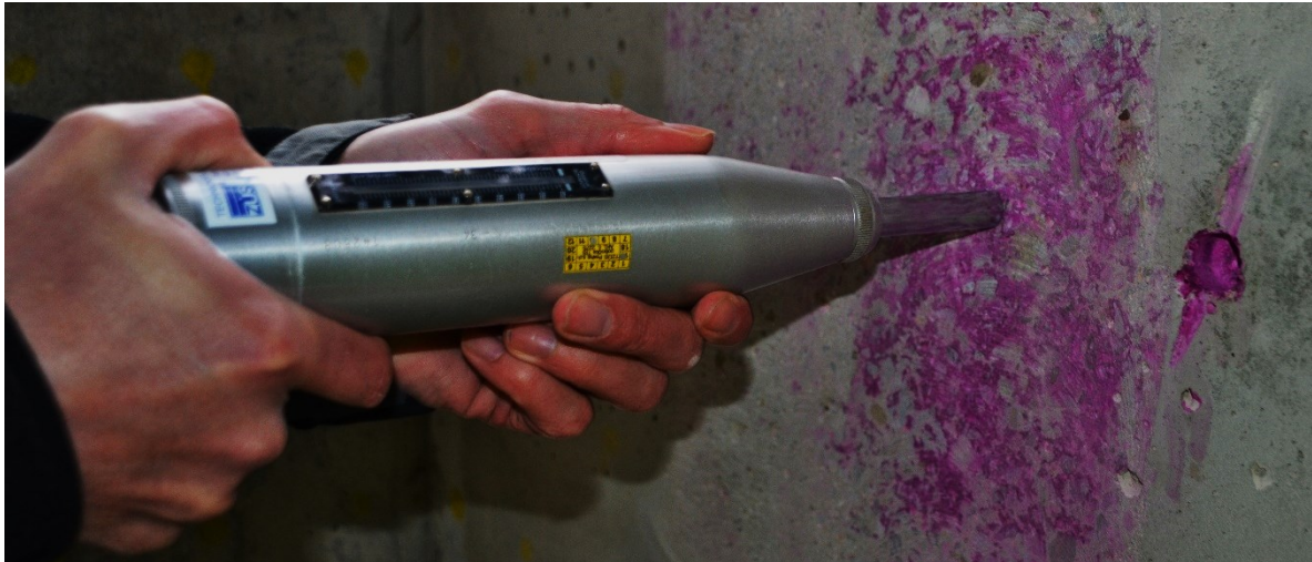
Obr. 33 Stanovení pevnosti v tlaku betonu odrazovým tvrdoměrem Schmidt N. Povrch betonu je nutné obrousit, aby byla viditelná struktura betonu. Fialová barva je způsobena reakcí fenolftaleinu (test karbonatace).
