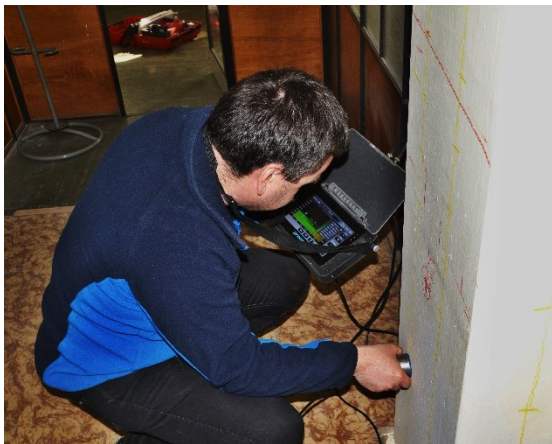
Obr. 34 Ultrazvukové měření (přímé prozvučování) na železobetonovém sloupu v budově nádraží Ostrava - Vítkovice.
