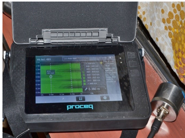
Obr. 35 Zobrazení mapy rychlostí šíření UZ impulzů v celé ploše zkoušeného železobetonového sloupu.
